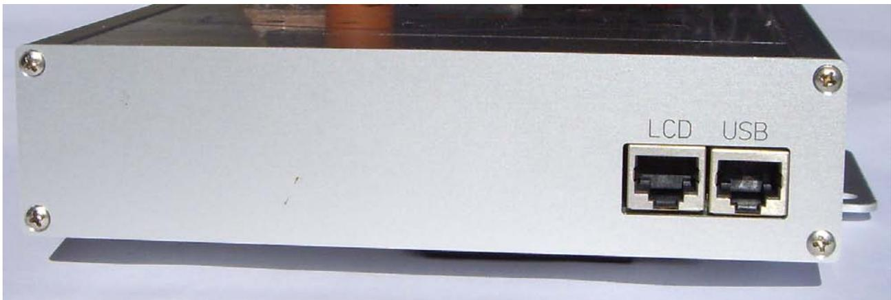
Die Anschlüssen an der Rückseite sind für das optionale 5" / 7" Touchscreen Display und die optionale USB Datenaufzeichnung.
